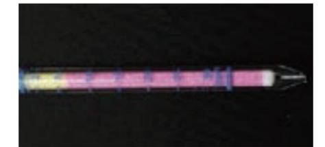
一定時間後のガス濃度を検知管で測定、減少率を算出します。
