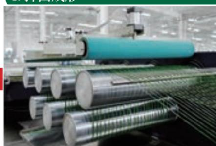
人工芝の原料であるポリエチレンやポリプロピレンを一度溶かし押出成形することにより、重みが加わっても倒れにくい芝を形作ります。
