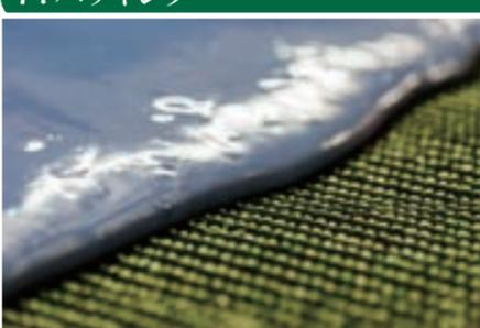
編みこんだ基布にさらにポリウレタン(PU)でコーティングをします。よくあるラテックス性よりも更に抜けにくく、高耐久な品質になります。
