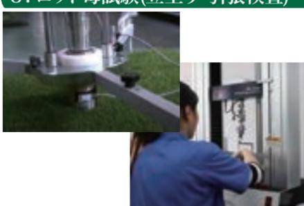
完成後は、様々な試験をロットごとに実施します。重みを加えて立上り力をテストしたり、一定の強さで引張り抜けないかを細かく試験します。
