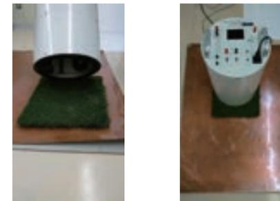
ゴムローラーを靴の代わりに銅板で帯電性試験をします。
